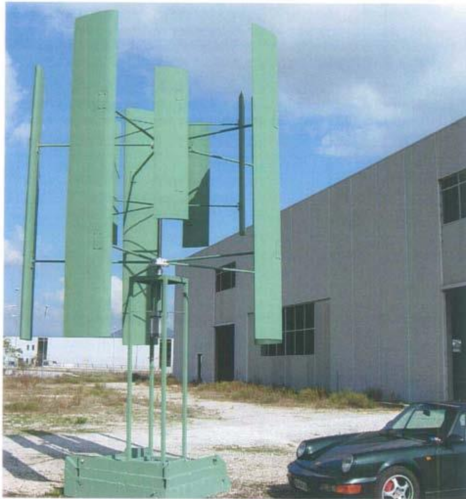
Installazione tipo industriale -ASIA-ITs 30/50 kWe
